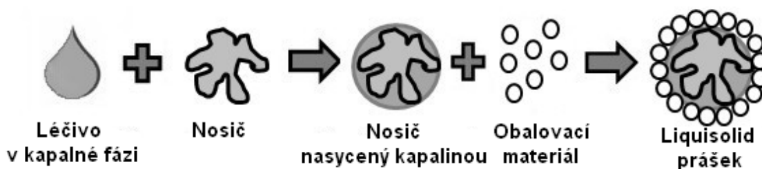
Obrázek 1: Schématické znázornění přípravy liquisolid prášku
