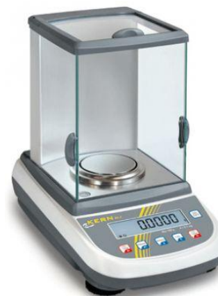
Analytické váhy; přesnost 0,0001 g
